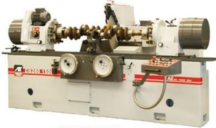
Krank taşlama uygulaması
