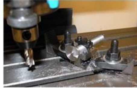
Özel bağlama aparatları ile bağlama
