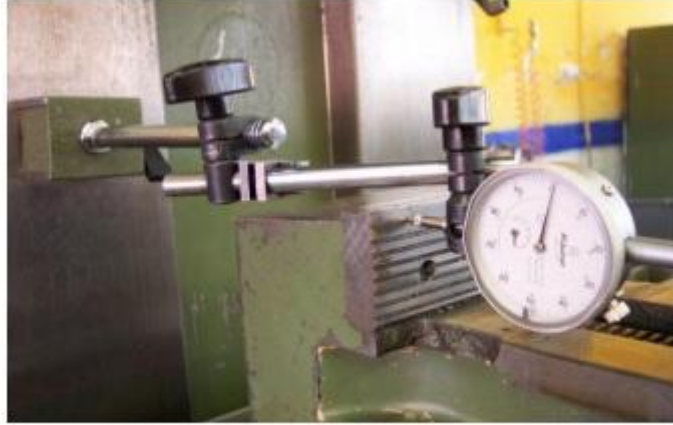
Mengene çenelerinin komparatör ile ayarlanması
