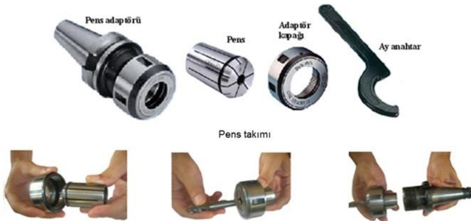
Pensle bağlama uygulaması
