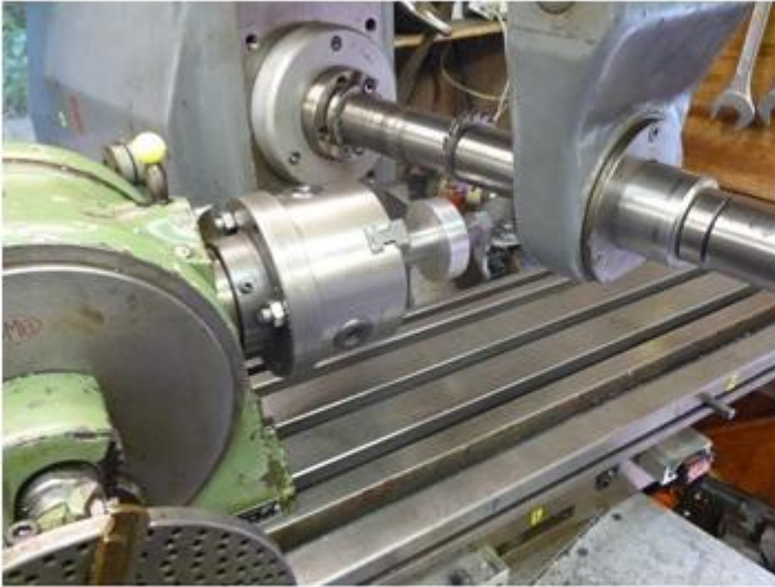
Divizör yardımıyla düz dişli açma işlemi
