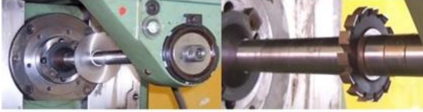
Kanal freze çakısının tezgaha bağlanması
