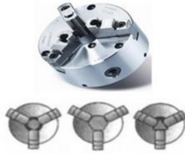
Farklı kesitteki parçaların bağlanması
