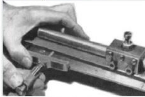
Sevk kızağının derinlik mikrometresi ile ayarlanması
