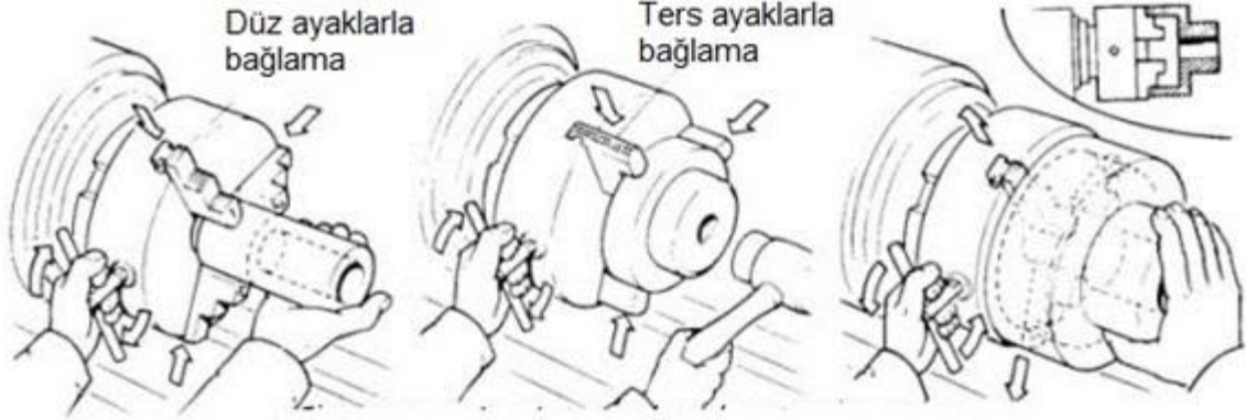
İş parçalarının düz ve ters ayaklarla bağlanması
