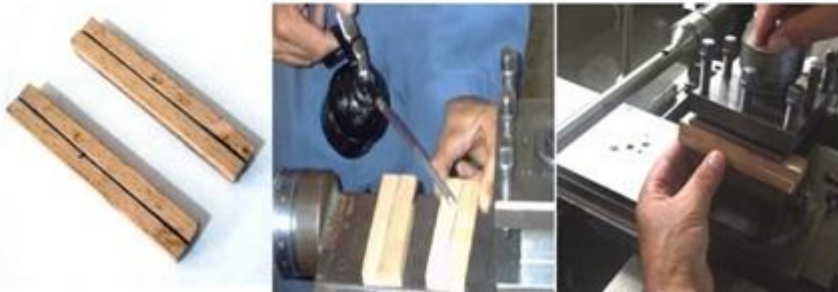
Yay sarma takozunun hazırlanması
